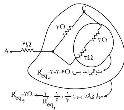
بنابراین شکل ساده شده مدار به این صورت است و
