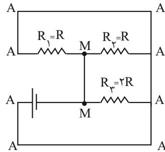
چون مقاومت  $R_3$ ، ۲ برابر مقاومت  $R_1$  و  $R_2$  است، پس جریان گذرنده از  $R_3$  و  $R_2$ ، ۲ برابر جریان  $R_1$  است.
